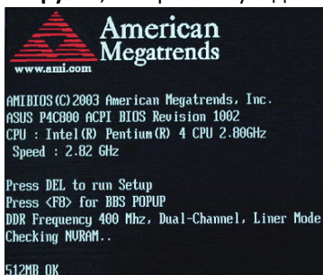
Вариант 1: Логотип производителя BIOS + результаты тестирования жизненных систем ПК
